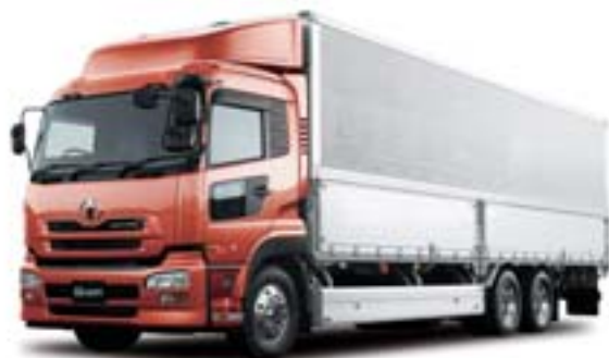
世界初の尿素SCRシステムを搭載した大型トラック「クオン」
