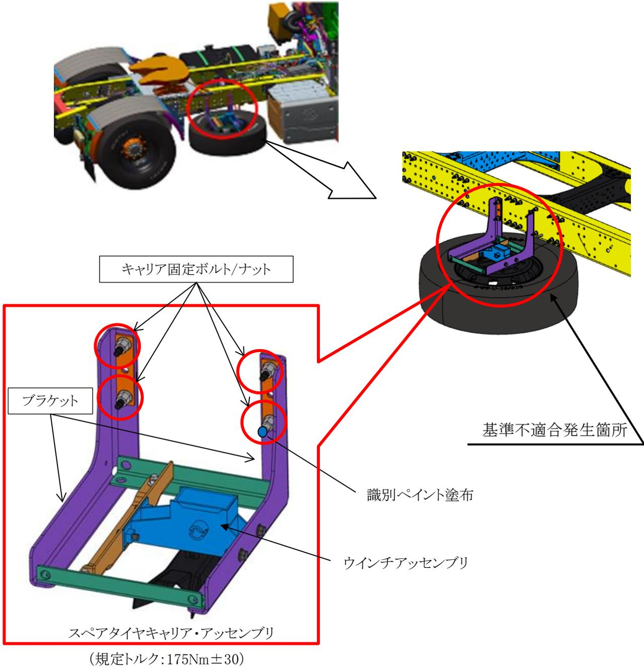
大型トラクタにおいて、スペアタイヤキャリアを車体に固定するボルト／ナットの締付けが不適切なため、締付けトルクが不足していることがある。そのため、そのままの状態で使用を続けると、走行時の振動等によりボルト／ナットが緩み、最悪の場合、ボルト／ナットが外れ、当該キャリアとともにスペアタイヤが脱落し、他の交通の妨げとなるおそれがある。
